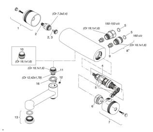
SE Blandaren kan ej byggas om mellan 150-153 c/c och 160 c/c med att byta anslutning. ENG The mixer cannot be rebuilt between 150 and 160 c/c by switching the connectors.
